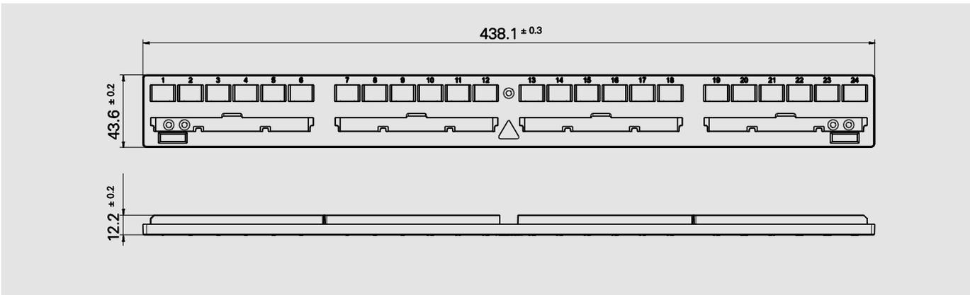
**24x E-2000™** (Placa frontal de metal com adaptadores parafusados)
