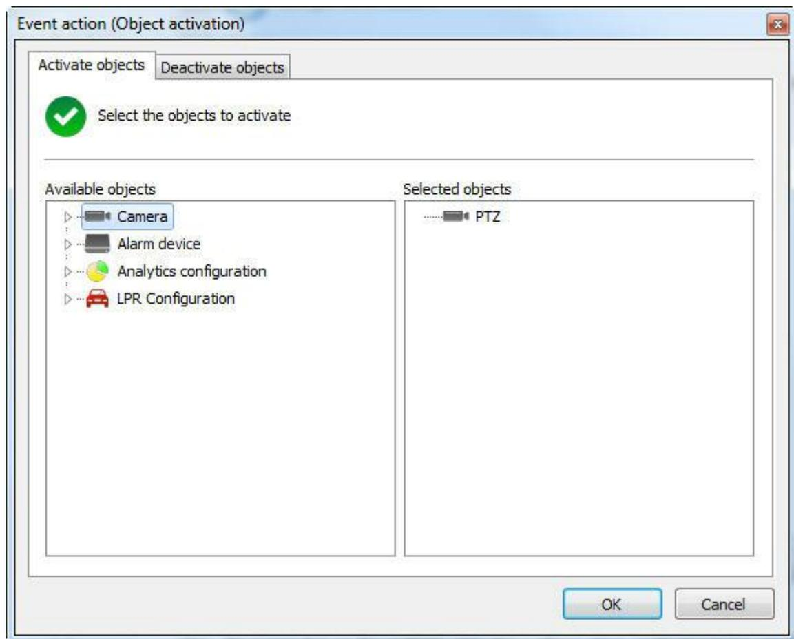
Pronto, de acordo com cenário proposto aqui, assim que o **servidor A** para de funcionar o **Servidor B** irá ativar a câmera "**PTZ**" e começar a gravar.
