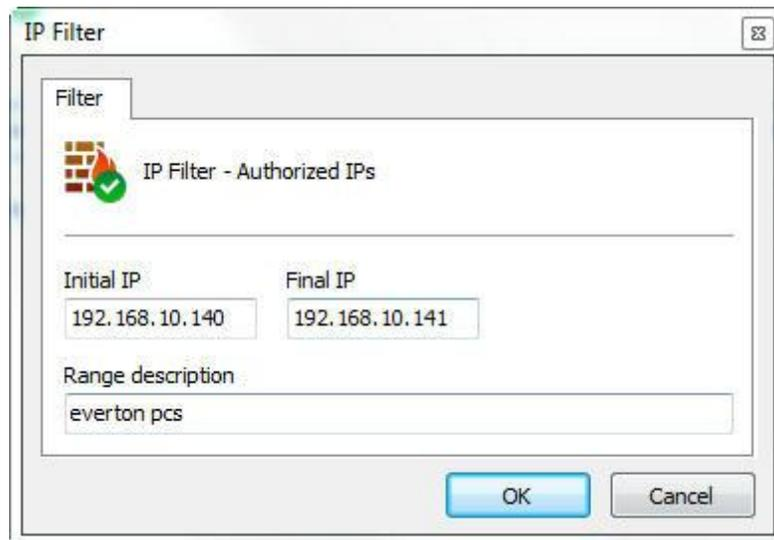
Entre com o IP inicial e o IP final do range e finalmente digite uma descrição para o escopo a ser adicionado.
