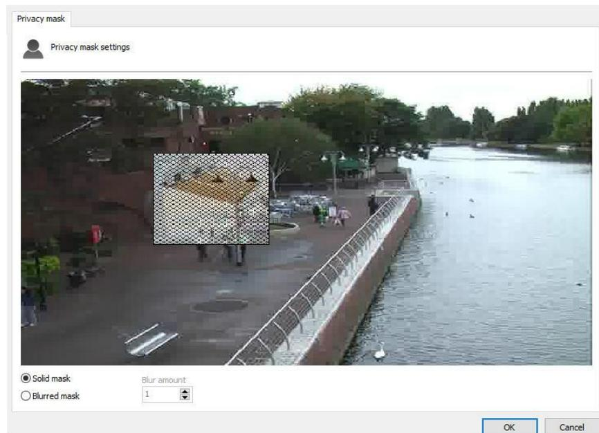
Para adicionar uma máscara de privacidade clique com o botão esquerdo do mouse sobre a imagem e arraste-o formando um retângulo. Para remover uma área selecionada faça um retângulo com o botão direito do mouse englobando toda a área da máscara a ser removida, ou clique em **Apaga Seleção** para apagar todas as máscaras criadas.
