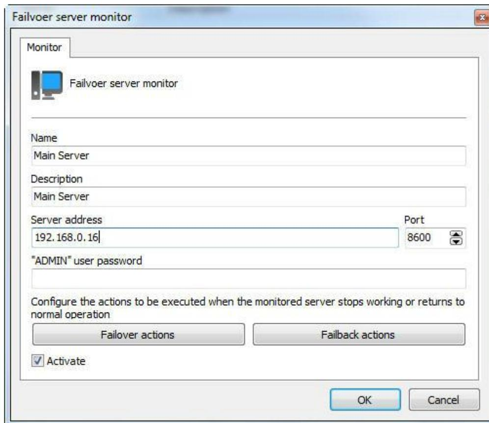
Para finalizar o processo, podemos configurar uma ação para quando o **servidor A** voltar em funcionamento. Basta clicar em **Ações de Failback**.
