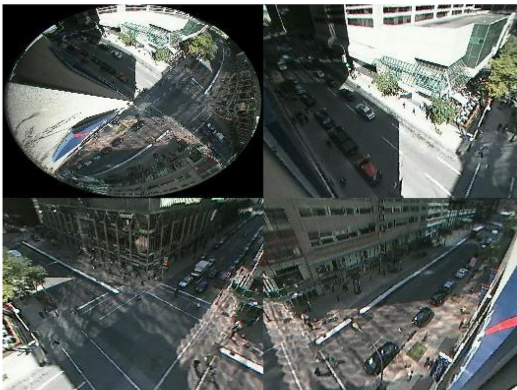
**OBS:** Lentes panorâmicas não funcionam como as lentes "fish eye", ou seja, uma câmera fish eye deve ser integrada de acordo com seu fabricante. A vantagem da lente panorâmica é que ela pode ser utilizada em qualquer câmera com sensor de 1/3.
