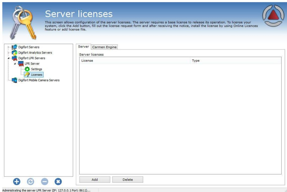
Nessa Aba “**Servidor (Server)**” é onde será instalada a base para que o LPR possa funcionar. Esse licenciamento é feito pela Internet, através de dados do cliente e de um número de protocolo enviados para o mesmo. Para efetuar a instalação da licença base clique em “**Adicionar (Add)**” e depois a seguinte tela será exibida:
