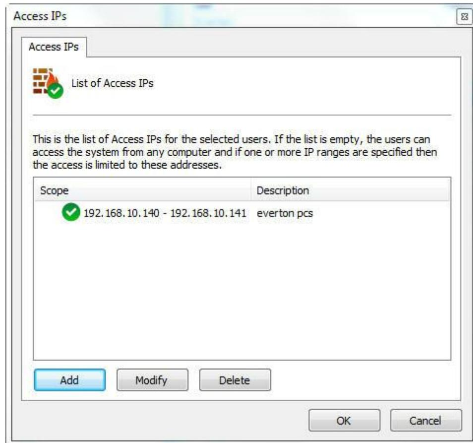
Na figura está sendo exemplificado uma configuração onde o usuário poderá se autenticar no sistema a partir dos IPs dentro do range 192.168.5.2 até 192.168.5.4.
