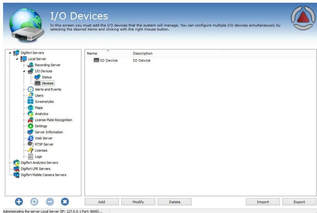
Para adicionar um dispositivo de alarme clique em **Adicionar**. Para alterar ou excluir selecione o dispositivo de alarme desejado e clique sobre o botão correspondente.
