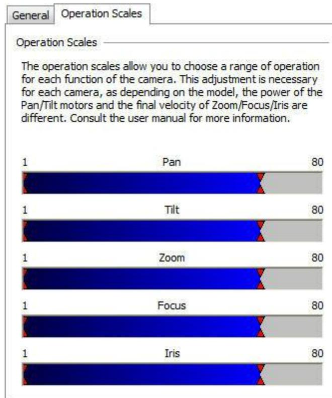
Essas configurações se aplicam a força dos motores. Para um melhor entendimento desta configuração vamos olhar para a barra de PAN. Se você segurar o joystick totalmente para a esquerda, a velocidade da câmera será de 80% da sua velocidade máxima. Também é possível especificar uma velocidade mínima de movimentação, ou seja, se você segurar o joystick somente alguns centímetros para a esquerda, a velocidade da câmera será de 5% da velocidade mínima da câmera.
