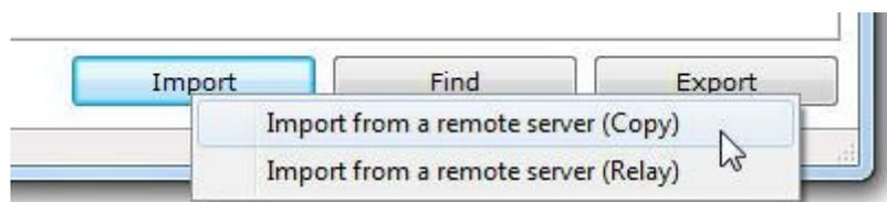
**Importar câmeras de um servidor remoto (cópia):** Quando a importação é feita como cópia, as configurações irão vir exatamente como do servidor importado. Um exemplo importante é a unidade de gravação: caso no servidor de origem as câmeras estiverem gravando no diretório E: e no servidor atual essa unidade não existir, a câmera não irá gravar.
