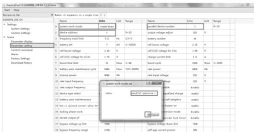
4. Conecte o segundo nobreak e configure *System Work Mode* para *Parallel Operation*, *Parallel device number* para "2", *Parallel device address* para "2", no menu *Parameter Setting*. Clique em para "3".
