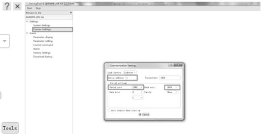
2. Selecione o menu *Settings*, configure a opção *Device address* para "1" e Baud rate para 9600. Selecione a porta serial utilizada no menu *Communication Setting*. Clique em *Ok* para se conectar ao nobreak.
