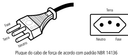
Plugue do cabo de força de acordo com padrão NBR 14136
