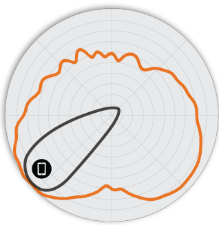
Figura 5. Padrões de antena de elevação R550 5 GHz
