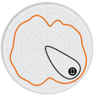
Figura 4. Padrões de antena de elevação R550 2,4 GHz
