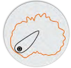
Observação: O traço externo representa o volume de RF composto de todos os padrões possíveis da antena BeamFlex, enquanto o traço interno representa um padrão de antena BeamFlex dentro do traço externo composto.
