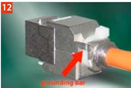
Sofern gewünscht, kann ein Potentialausgleichskabel mittels Flachkabelstecker 2,8 mm direkt am Modul angeschlossen werden.
