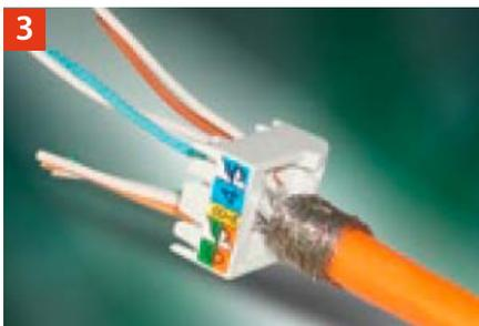
Die Adernpaare ohne Folienschirme entsprechend dem gewählten Farbcode durch die Öffnungen im Aufteiler stecken und so festziehen, dass das Kabel am Aufteiler endet.
