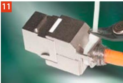
Bitte positionieren Sie das Ende des Kabelbinders so wie dargestellt. Den überstehenden Rest des Kabelbinders so dicht wie möglich abschneiden.
