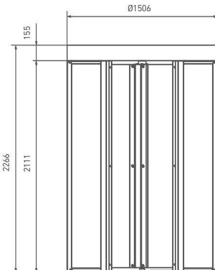
\*Embora a altura do equipamento seja de 2266mm, a altura mínima necessária para instalação é de 2566mm.
