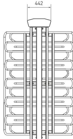
\*Embora a altura do equipamento seja de 2250mm, a altura mínima necessária para instalação é de 2350mm.
